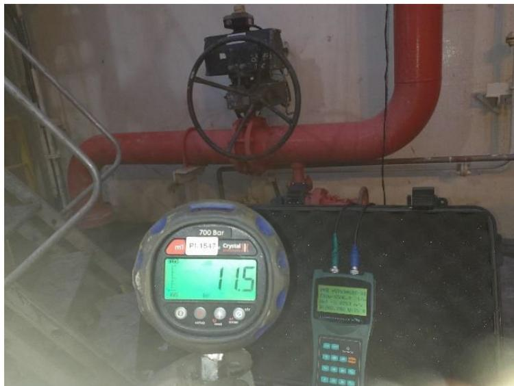
Figura 6: Medição de vazão e pressão na linha da ADV
